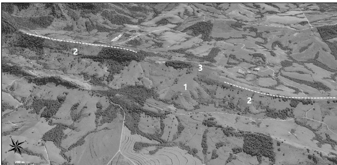
**Figura 7:** Vista parcial da bacia do ribeirão Laçador, onde é evidenciada uma importante anomalia ao longo da do divisor hidrográfico, associada a descontinuidade do dique de diabásio. 1 – Anomalia semi-elíptica de relevo; 2 – Diques de diabásio (pontilhados); 3 – Zona de deslocamento do dique de diabásio. Fonte: Google Earth Pro® (2017).
