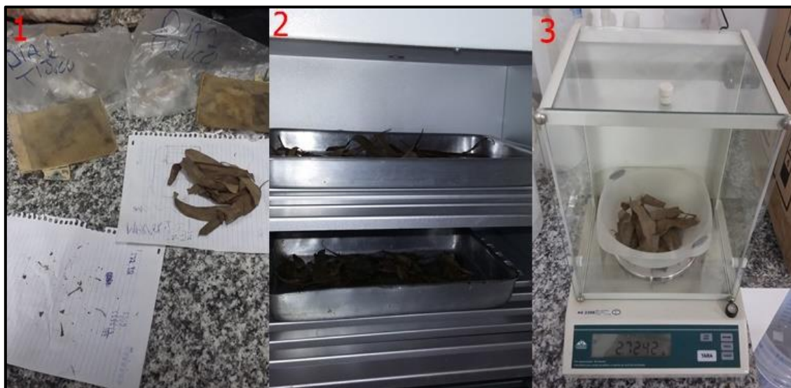
Figura 5: Processos realizados em laboratório, para mensuração da perda de massa da serrapilheira foliar das amostras: 1- Triagem do Material; 2 - Secagem em Estufa; 3 - Pesagem do material.
