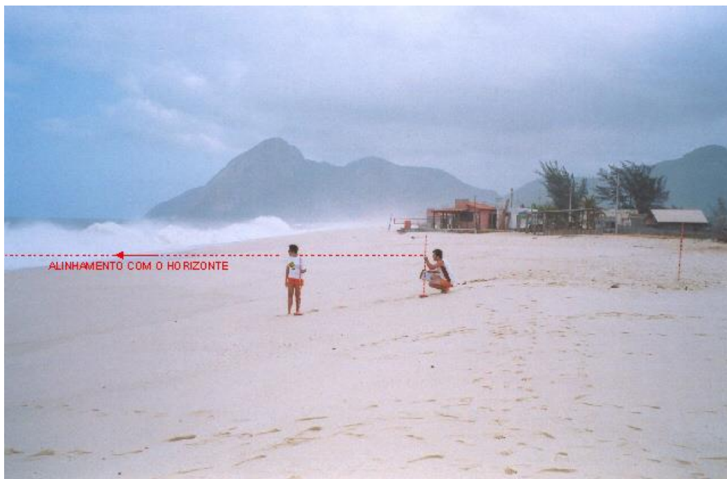
Figura 3. Perfilagem. A distância horizontal é determinada de modo a acompanhar as mudanças morfológicas da praia. Fonte: SILVA, M. A. M. (2002).
