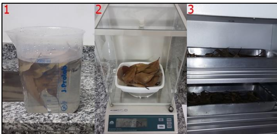
Figura 6: Processos realizados em laboratório para mensuração da capacidade de retenção hídrica do material amostrado: 1 - Material imerso na água; 2 - Pesagem do material úmido; 3 - Secagem em estufa, para posterior pesagem do material seco.
